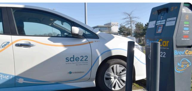
Le réseau Brev'Car (Bornes de recharge électrique pour véhicules en Côtes d'Armor) compte 171 bornes accélérées (22kW) et 8 bornes rapides (50kW). En 2022, 61 795 recharges ont été effectuées, ce qui représente 7 043 079 km parcourus.
